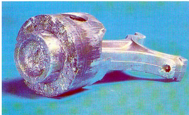
Piston deteriorat în urma loviturilor hidraulice
