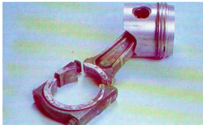
Ambielaj al unui compresor supraîncălzit
